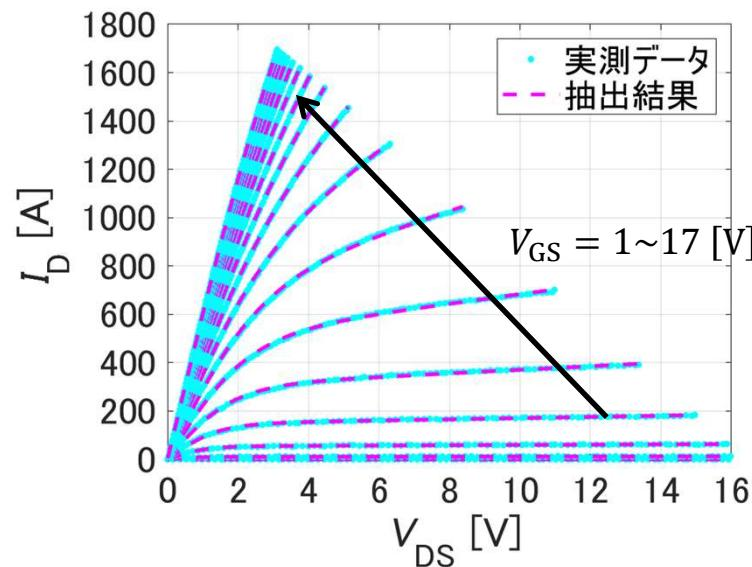
Target : 1.2kV-Full SiC module
